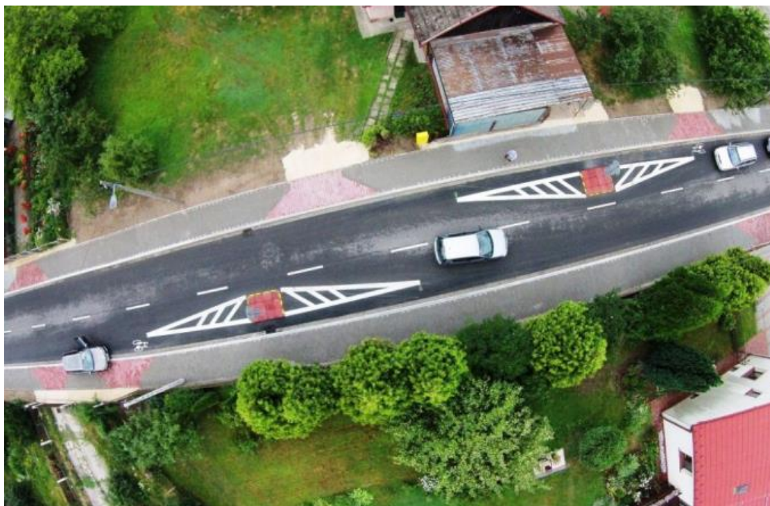
Rysunek 29. Przykład szykany stosowanej w celu spowolnienia ruchu Źródło: ZIKIT Kraków (obecnie ZDM).
